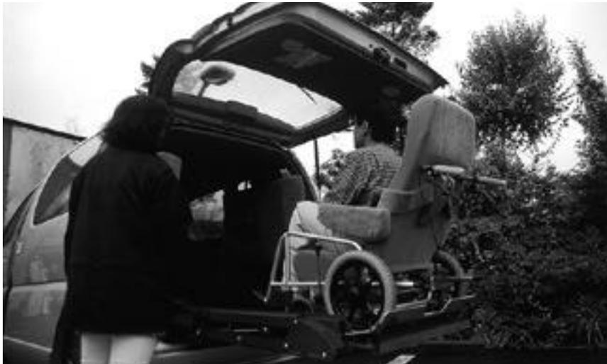
エルグランドの「チェアキャブ」モデルでは、車イスは油圧と電動で昇降する。車イスが車内に乗り込んだ後は、ワンタッチで固定される。
