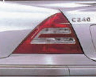
Sクラスにソックリのリアコンビランプも、Cクラスではワイドに見せるアイテムとして採用。汚れ付着防止のため...
